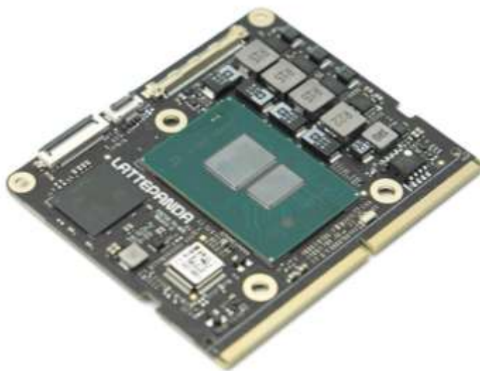
Рис. 1.8 Одноплатний комп'ютер LattePanda Mu SoM ( https://www.cnx-software.com/ )
