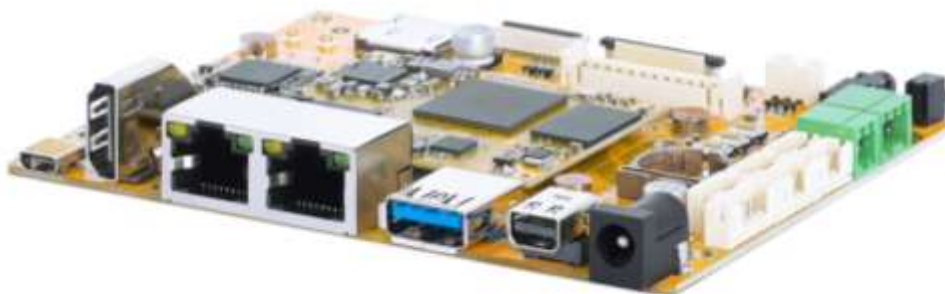
Рис. 1.4 Одноплатний комп'ютер Boardcon SBC3576
