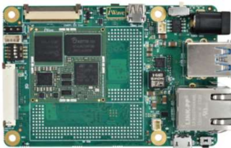
Рис. 1.5 Одноплатний комп'ютер iWave Systems iW-RainboW-G54S
