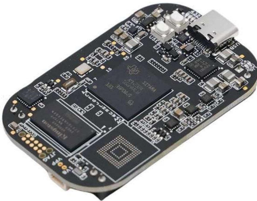
Рис. 1.2 Одноплатний комп'ютер PocketBeagle
