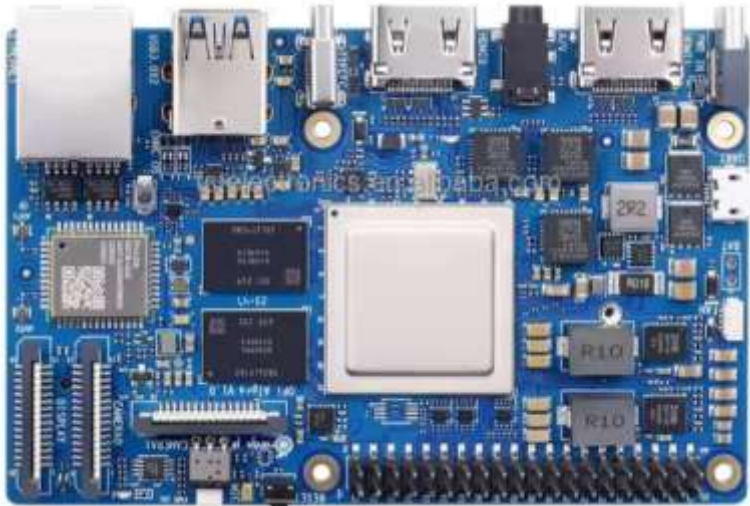
Рис. 1.3 Одноплатний комп'ютер Orange Pi AIPro (8T)
