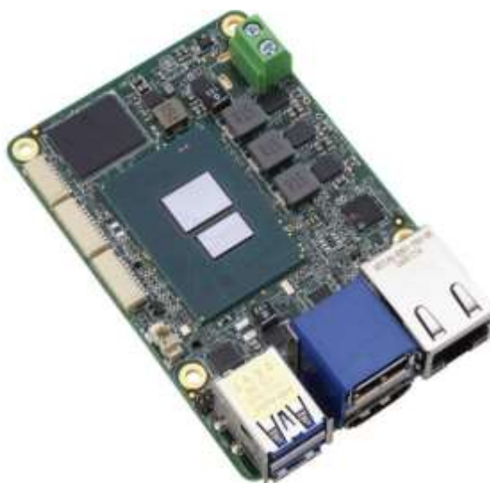
Рис. 1.7 Одноплатний комп'ютер UP 710S ( http://liliputing.com/ )
